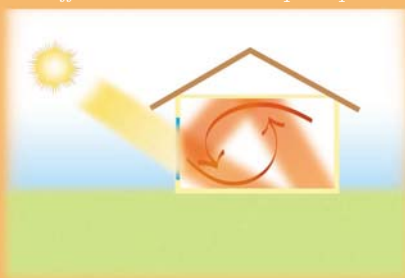
Effet de serre : schéma de principe
