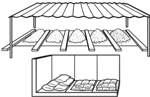
Aires de stockage pour le sable tamisé et lavé/emballé
