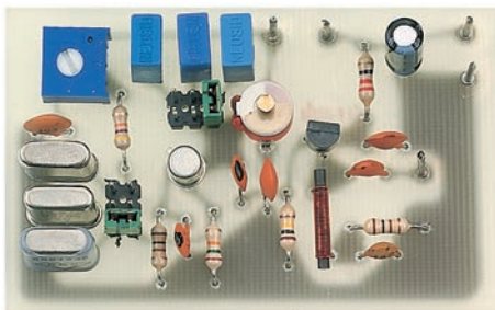
Figure 346: Photo d'un des prototypes de la platine de l'étage oscillateur testeur de quartz. Dans la deuxième partie de la Leçon nous procéderons aux essais, réglages et utilisation : vous aurez besoin de la sonde de charge EN5037 et d'un multimètre.
