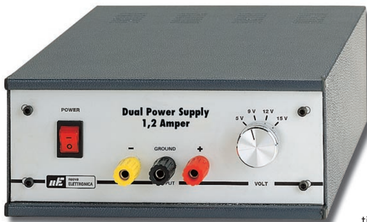
Figure 69 : Photo de l'alimentation double de 5, 9, 12 et 15 volts, capable de débiter un courant maximal de 1,2 ampère.
