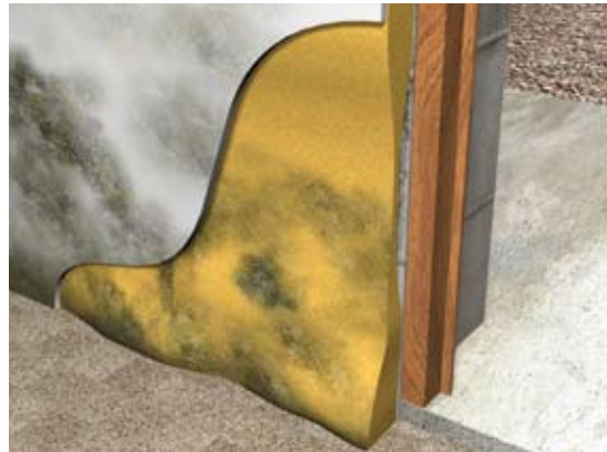
Dégradation d'un doublage isolant.
